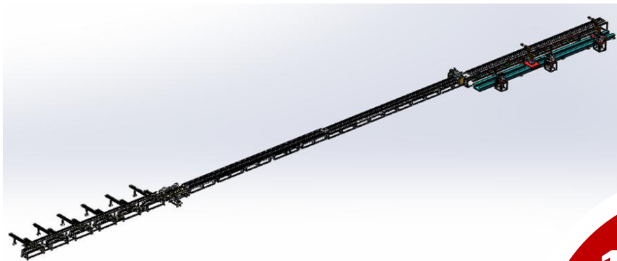
1、设备自动排序取料，自动输送，完成定长切割、缺口切割，并自动输送到下一工位
